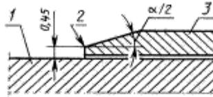
1 — поверхность стебля; 2 — измерительная кромка; 3 — барабан
